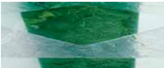
Serpentinit wird durch die Bearbeitung mit diamantbesetzten Bürsten rutschfester.
